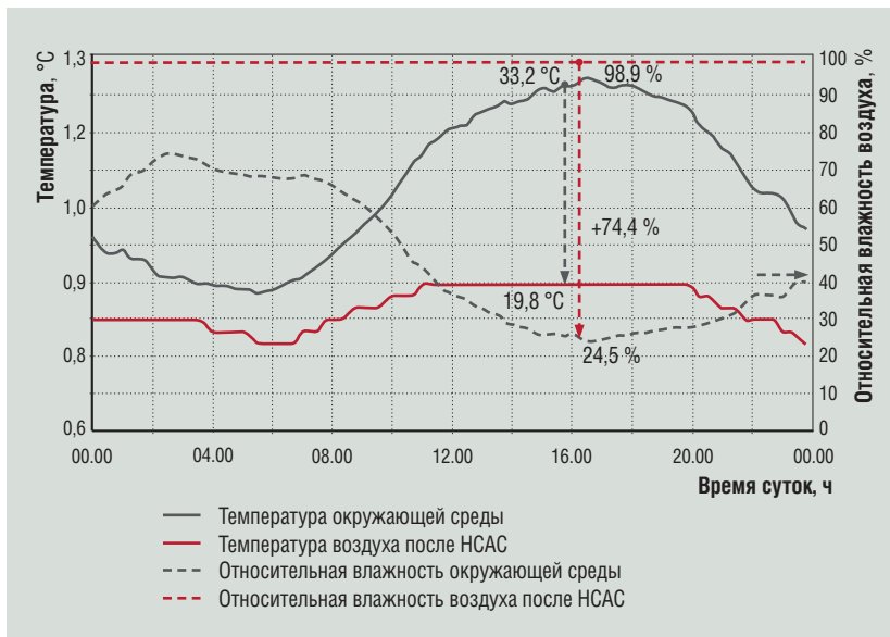
Рис. 6. Графики температуры и влажности атмосферного воздуха и воздуха после гибридной установки (НСАС) на примере ГТУ №1
